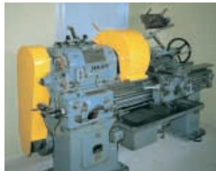
Figure 27 Marquage de protecteurs
