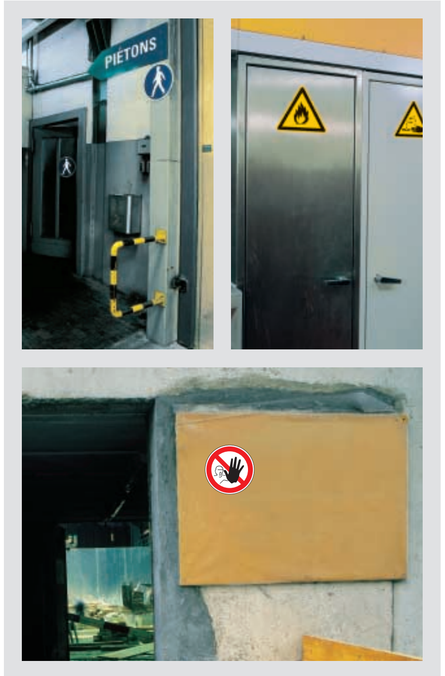
Figure 1 Signalisations de sécurité
