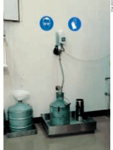
Figure 23 Poste de travail nécessitant la manipulation de liquides corrosifs. Le port de lunettes et de gants de protection est prescrit au moyen des deux signaux d'obligation.
